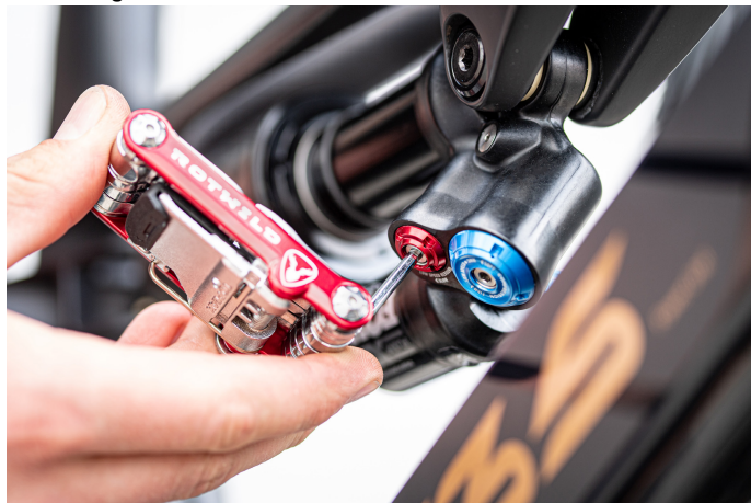
Fig. 30: Nivel de tracción del amortiguador de la horquilla trasera R.E735
