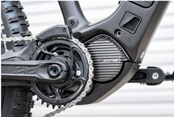
Fig. 14: Sistema de propulsión eléctrico R735
