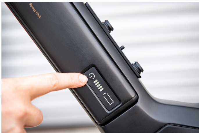
Fig. 2: Conectar y desconectar el R375
