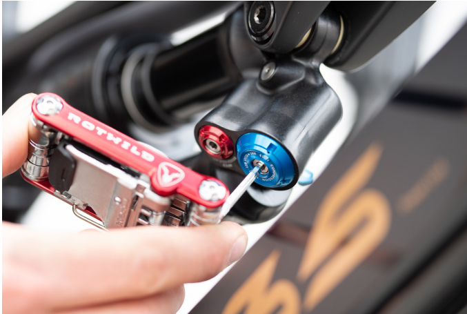
Fig. 28: Nivel de presión del amortiguador de la horquilla trasera R.E735
