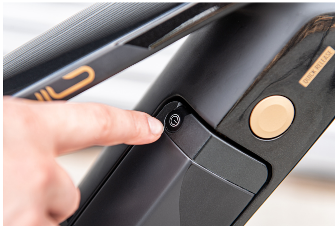
Fig. 3: Conectar y desconectar el R735
