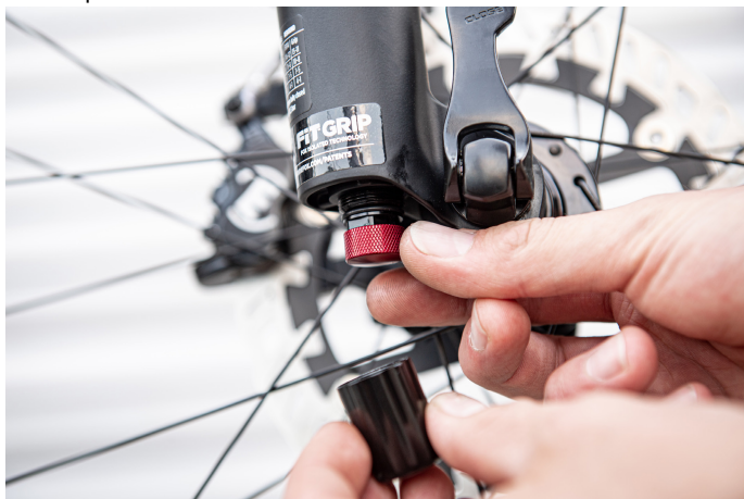
Fig. 27: Nivel de tracción de la horquilla de suspensión
