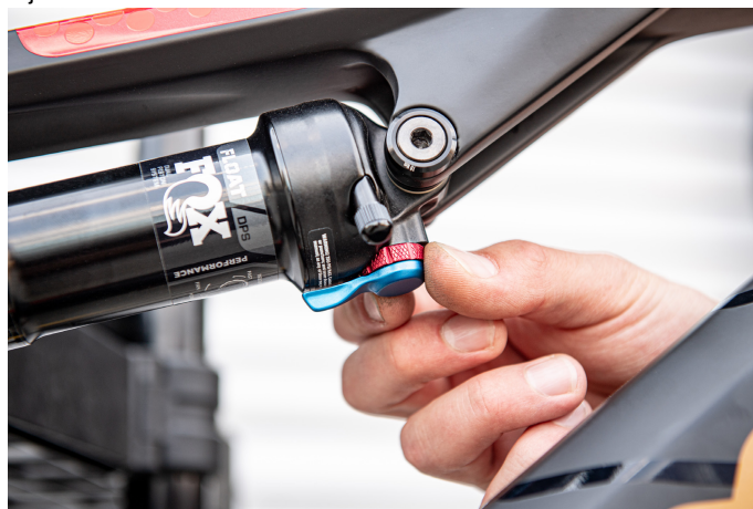
Fig. 31: Nivel de tracción del amortiguador de la horquilla trasera
